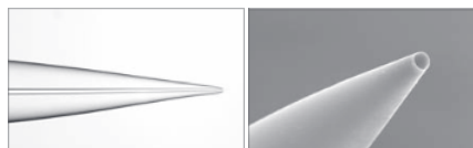
Figure 51 : Photographie d'un capillaire nanoESI (SillicapTip™, New Objective).
